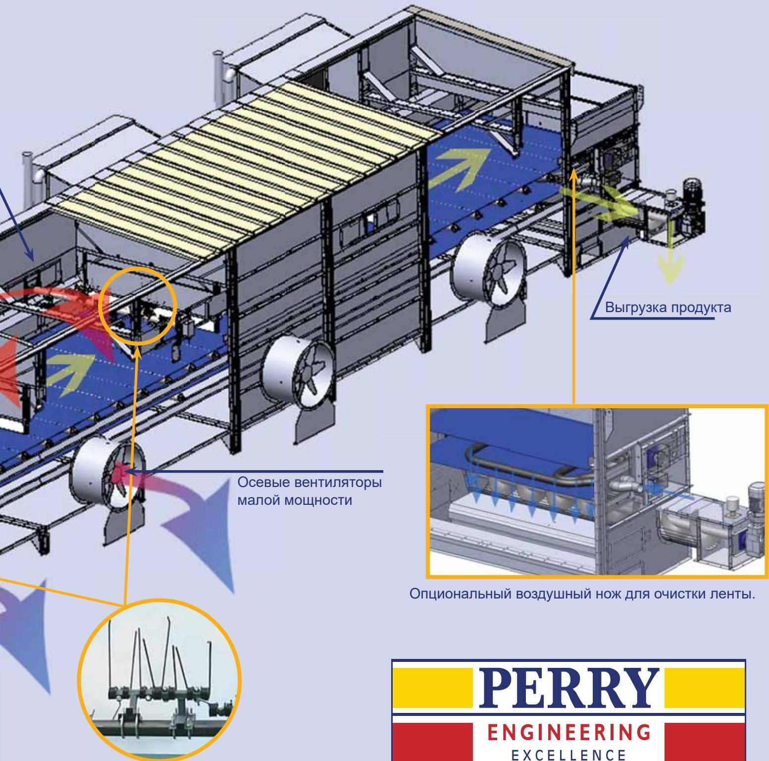
Опциональные мешалки для продукта, способствующие равномерной сушке.
