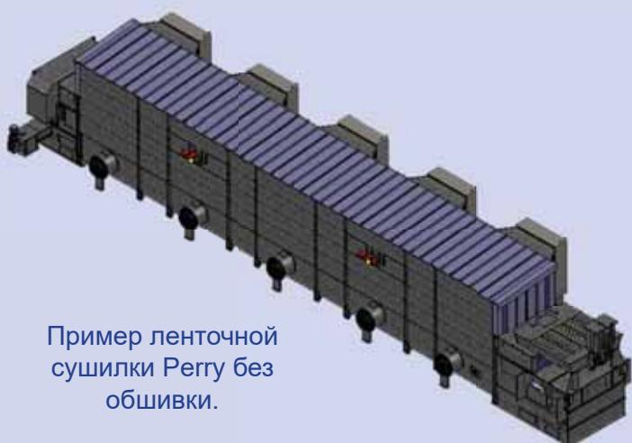
Пример ленточной сушилки Perry без обшивки.
