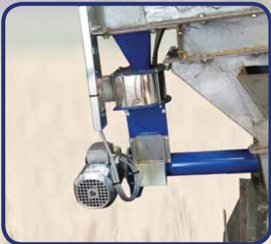
Автоматический датчик влажности предназначен для постоянного измерения влажности на входе и/или выходе сушилки непрерывного действия со смешанным потоком.
